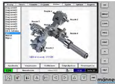
Realdarstellung des Heißkanals
