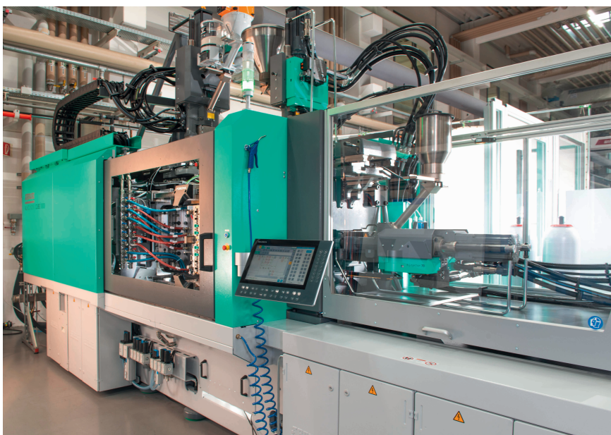
Blick in die Spritzgießmaschine: Auf einer Arburg Allrounder Cube 1800 wurde die synchrone Formfüllung, Kühlung und Teileentnahme auf der K demonstriert. © Foboha
